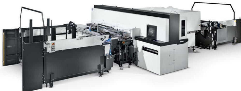
Die Delta Multipass Drucksysteme können spezifisch an die unterschiedlichen Kundenanforderungen angepasst werden. Durch die Kombination der verschiedenen Peripherie-Komponenten wird von der einfachen manuellen Lösung bis hin zur vollautomatischen Zu- und Abführung alles abgedeckt.
